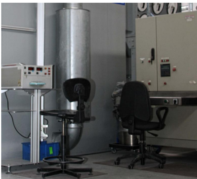
Rys. 5. Stanowisko do selekcjonowania warystorów wraz z generatorem uderzeń prostokątnych
