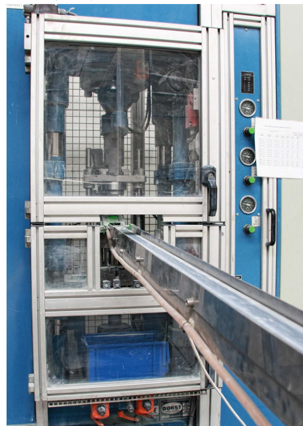
Rys. 3. Prasowanie granulatu na prasie hydraulicznej
