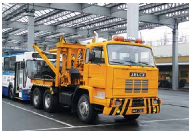
Fot. 14. Holownik (nr 39103 w Gdyni) z widocznym systemem żurawików przeznaczonych do holowania pojazdu z uniesioną osią. Fot. M. Połom
