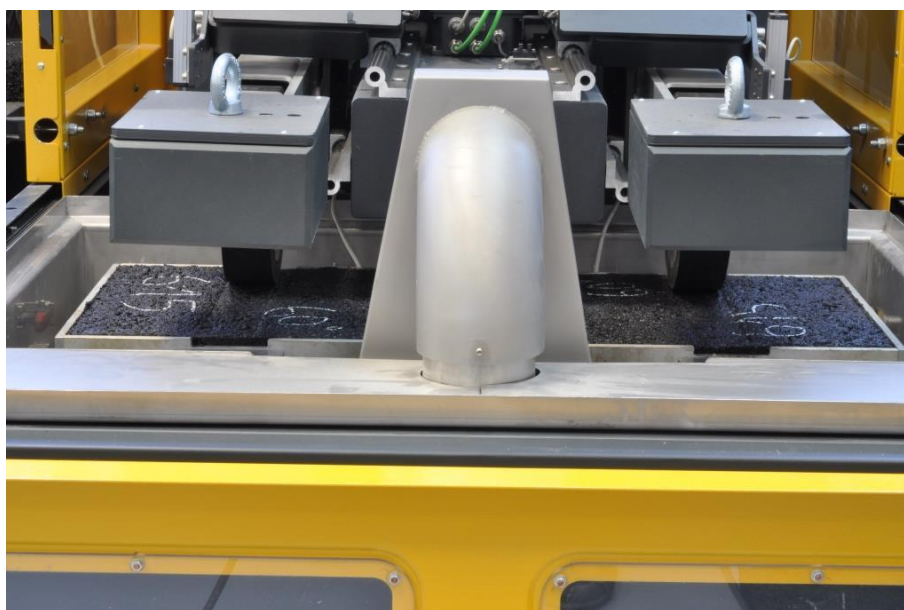
Rysunek 2 Widok próbek podczas badania koleinowania
