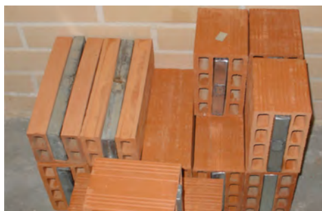
Rys. 2. Pustaki ceramiczne z wkładem z materiałów zmiennofazowych [4]
