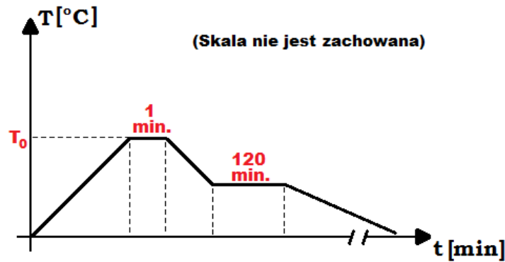
Rys. 2. Schemat grzania próbek materiału w piecu grzewczym.
