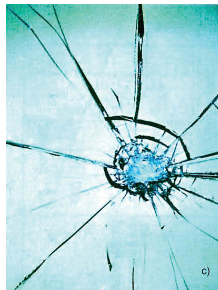
Rys. 7. Zmiana rozkładu naprężeń w szkłe pod wpływem wzrastającego obciążenia prostokątnego do powierzchni tafli
