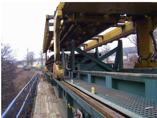
Rys. 2. Pociąg P-93: z lewej transport podkładów, z prawej wymiana szyn
