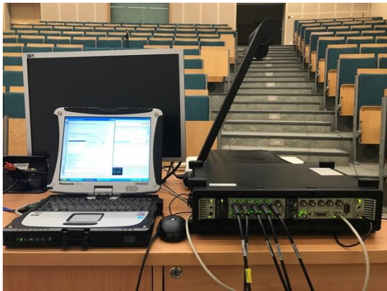
Rysunek 6-17 Sprzęt pomiarowy wykorzystany podczas badań: system PULSE (po lewej), analizator NTI AL1 (po prawej)
