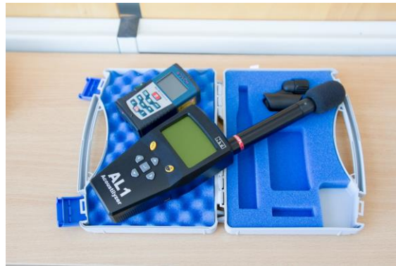
Rysunek 6-17 Sprzęt pomiarowy wykorzystany podczas badań: system PULSE (po lewej), analizator NTI AL1 (po prawej)
