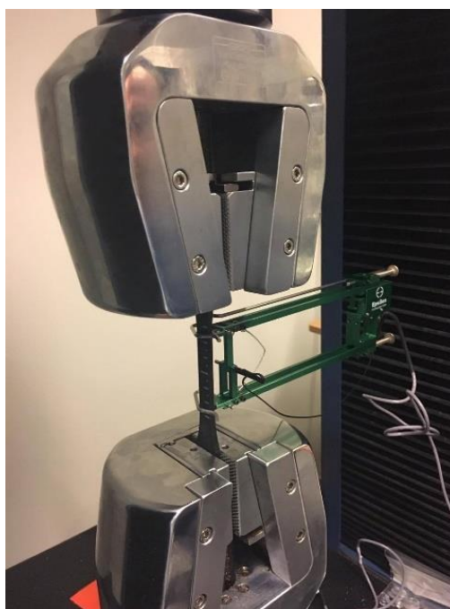
Rys. 38. Statyczna próba rozciągania wydruku 3D – pomiar wydłużenia za pomocą ekstensometru Epsilon 3542-050M-025-HT1
