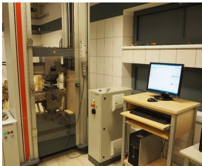
Rys. 59. Stanowisko badawcze do jednoosiowej próby ściskania
