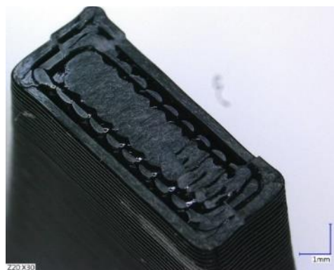
Rys. 67. Złom próbki wydrukowanej w orientacji Z
