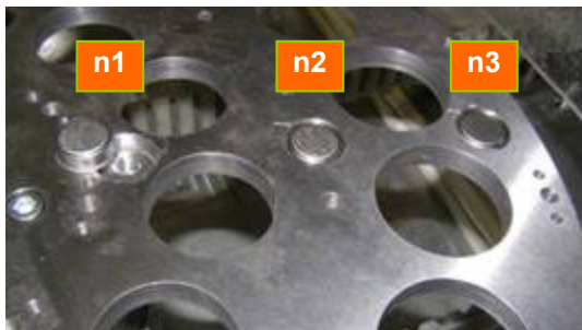
Rys. 3. Korpus narzędzia z czujnikami temperatury (n1+n3) umieszczonymi w nieprzelotowych otworach, przed przykręceniem ściernicy o spoiwie galwanicznym
