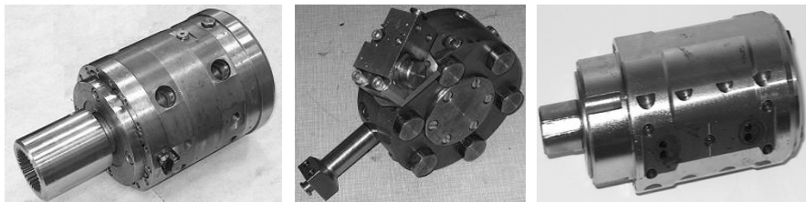
Rys. 1. Silniki satelitowe. Od lewej: typ HS, typ HF, typ SM (silnik badany).
