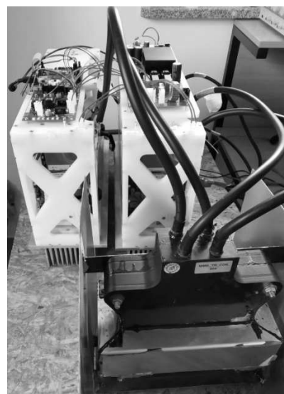
Rys. 4. Izolowana celka AC-DC-DC-AC z tranzystorami SiC MOSFET oraz transformatorem pracującym z częstotliwością 30 kHz [6]
