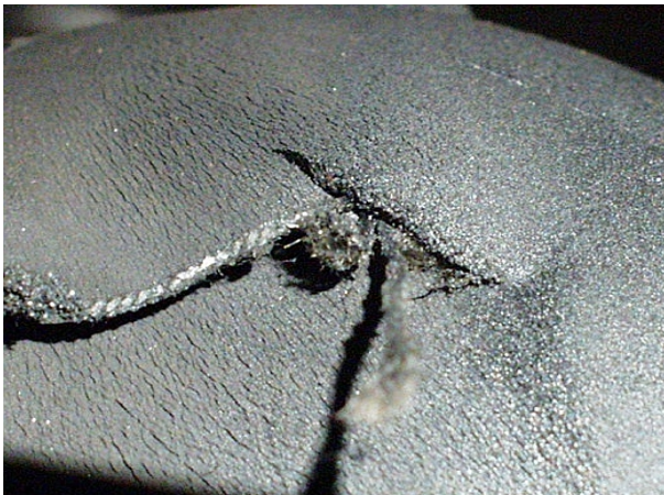
Rys. 2.1. Uszkodzenia zmęczeniowe wałów napędowych statków:
