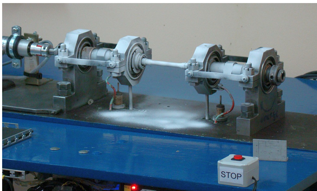
Rys. 4.7. Widok badanego układu mechanicznego przygotowanego do pomiaru współosiowości
