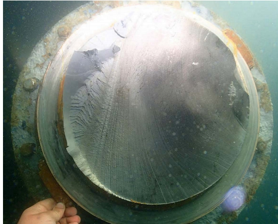
Rys. 2.1. Uszkodzenia zmęczeniowe wałów napędowych statków:
