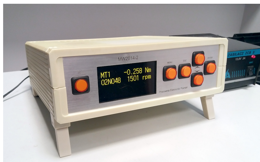
Rys. 4.14. Widok ogólny mikroprocesorowego miernika momentu i prędkości obrotowej typu MW2014-2
