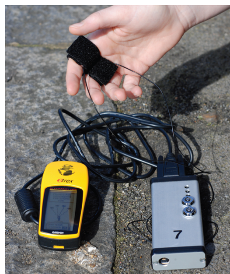
il. 33. Urządzenie Bio Mapping : GPS po lewej, opaski z czujnikami na palce; u góry, rejestrator danych po prawej stronie zdjęcia, źródło: Nold Ch. (red.) Emotional Cartography: technologies of the Self . Creative Commons, http://www.emotionalcartography.net/EmotionalCartography.pdf [dostęp: 15.07.2020 r.]
