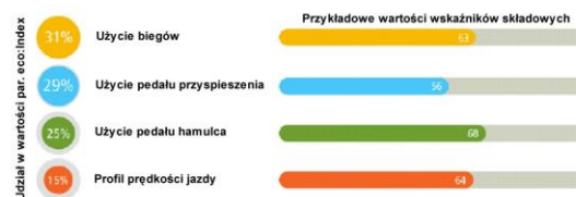
Rys. 3.2. Wagi używane przy obliczaniu łącznego wskaźnika eco:Index [13]
