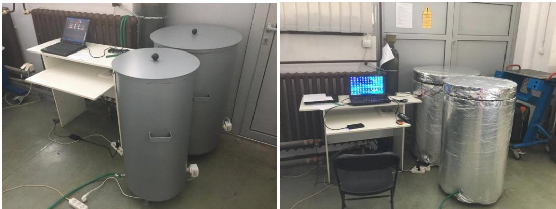
Rysunek 84. Wygląd przygotowanego stanowiska c.w.u. przed i po modyfikacji – duża skala
