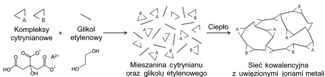
Rys. 22 Schemat przebiegu syntezy metodą Pechiniego [64]
