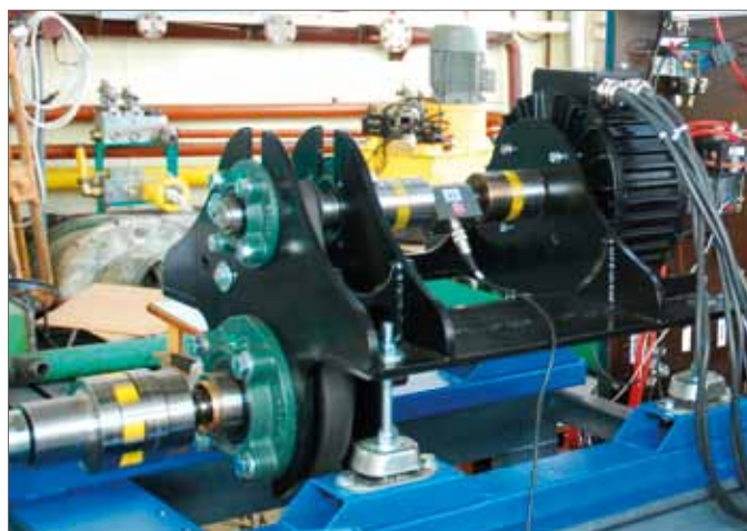
Rys. 10. Zaprojektowany przez autorów artykułu prototypowy układ napędowy podczas badań laboratoryjnych; w miejscu sprzęgła sterowanego zainstalowano momentomierz niezbędny do wyznaczenia charakterystyki układu napędowego [12]
