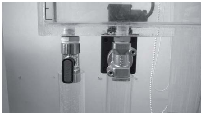
Rys. 3. Para zaworów – ręczny (lewy), sterowany (prawy) Fig. 3. Pair of valves – manual (left), controllable (right)
