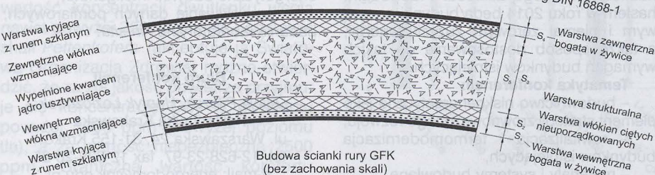
Rys. 1. Struktura rury nawojowej z żywicy poliestrowej wzmocnionej włóknem szklanym UP-GF z wypełniaczem, według DIN 16868 [4, 5] (źródło: broszura informacyjna firmy Amitech Poland)
