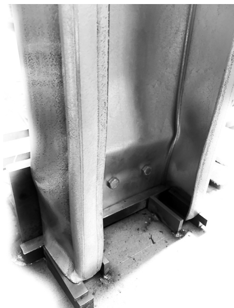
Rys. 7.8. Deformacja konstrukcji a) zdjęcie pochodzące z eksperymentu, b) wynik analizy MES.
