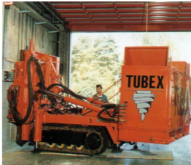
Rys. 5. Maszyna do wykonywania pali Tubex
