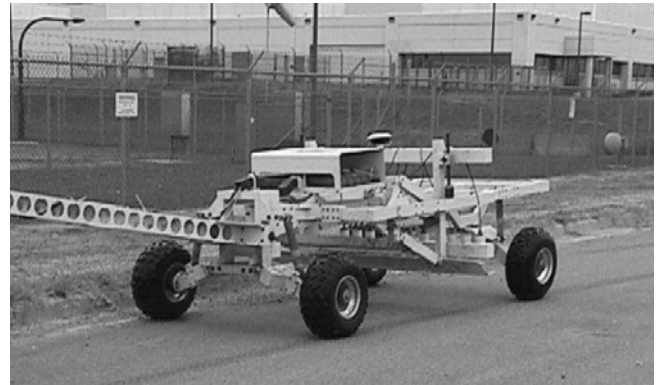
Rys. 8. System magnetometryczny na pojeździe [12]
