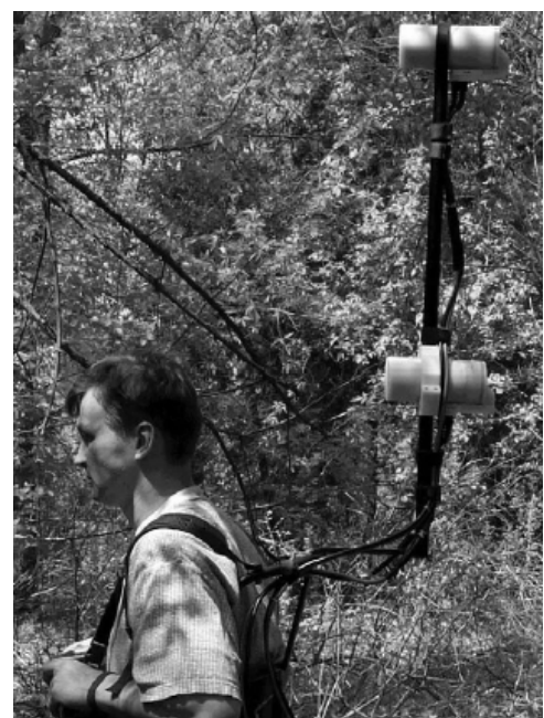
Rys. 10. System magnetometryczny z magnetometrami protonowymi (www.gemsys.ca)
