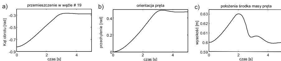
Rys. 4. Przemieszczenia wybranych elementów układu: kąt obrotu w węźle przedramienia (a); kąt przechylenia pręta (b); położenie środka masy pręta (c)
