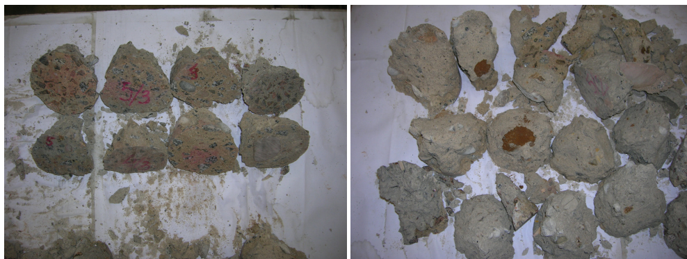
Rysunek 3. Widok na próbki starego betonu po badaniach wytrzymałościowych
