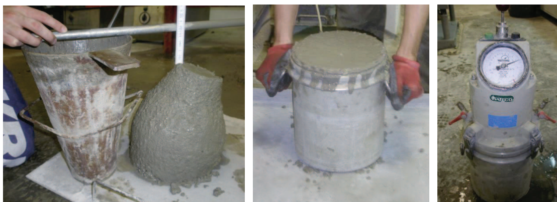
Rys. 4.1. Badania mieszanki betonowej
