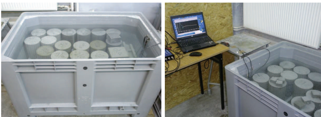
Rys. 4.4. Rozformowane próbki dojrzewające w kąpielii wodnej i dalszy monitoring temperatury
