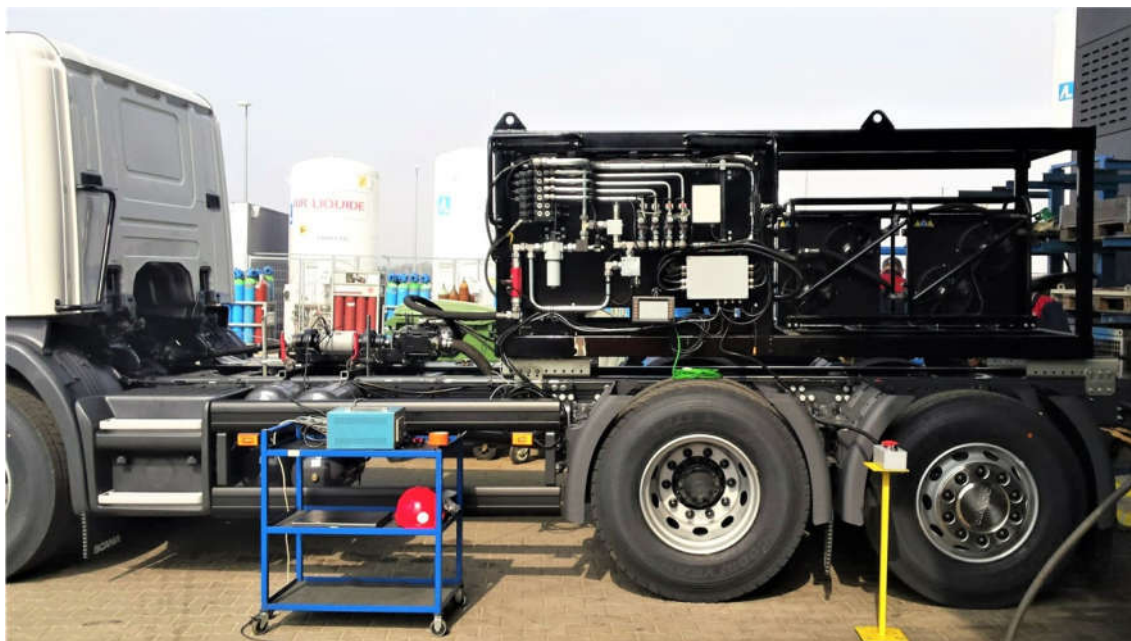
Rys. A.17. Stanowisko zamontowane do ramy podwozia marki Scania
