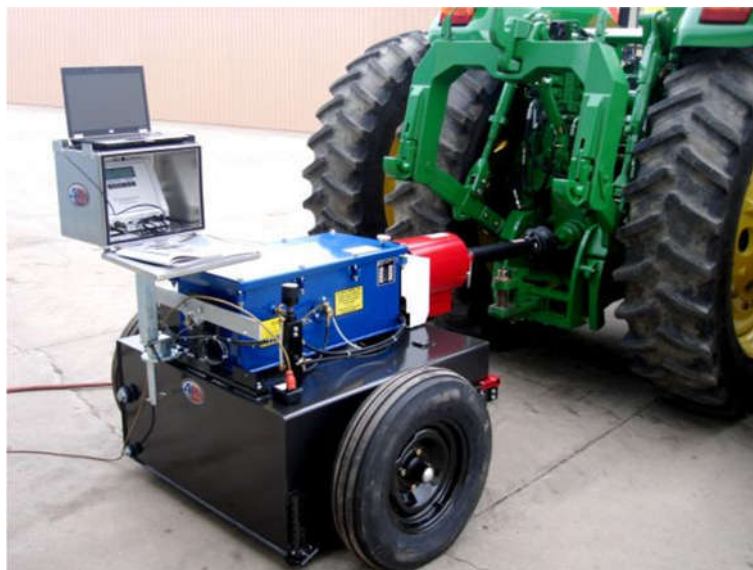
Rys. A.7. Przenośna hamownia WOM podczas obciążania silnika w ciągniku rolniczym [152].
