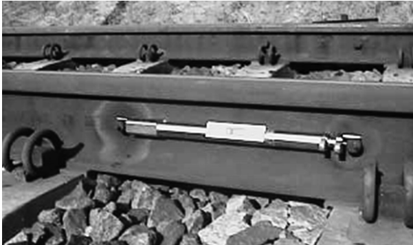
Rys. 2. Miernik sił podłużnych w szynach MS-02 [28]
