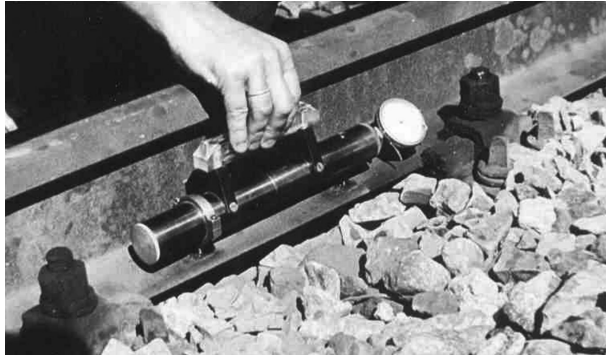
Rys. 1. Widok ekstensometru w położeniu pomiarowym Fig. 1. View of an extensometer at the measuring attitude
