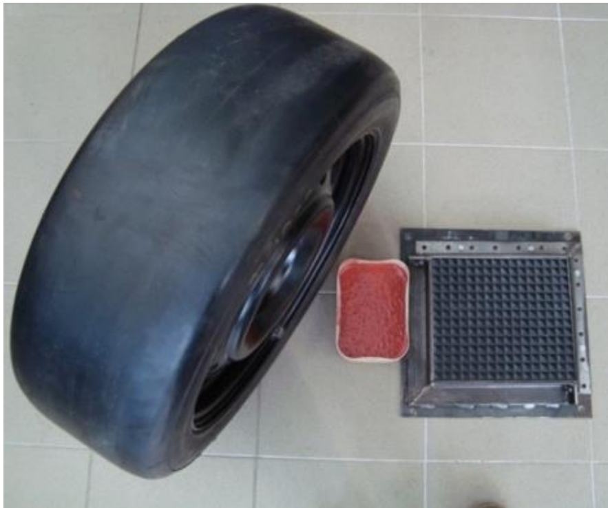
Rys. 45 Stanowisko do wykonywania odcisków opony: badane koło, silikon do odlewania, badana replika umieszczona w ramce.
