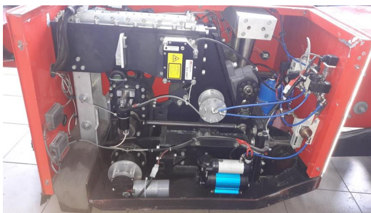
Rys. 8 Urządzenie pomiarowe przyczepy pomiarowej R 2 Mk.2.
