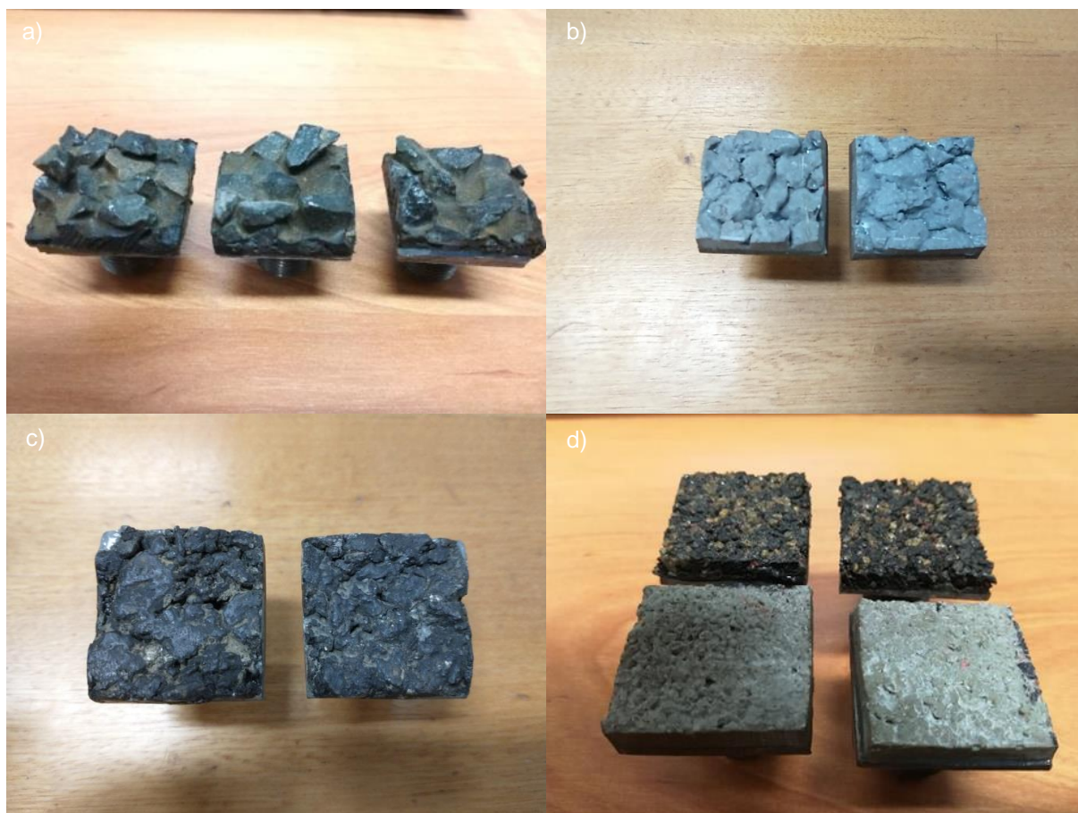
Rys. 25 Penetratory odpowiadające rzeczywistym nawierzchniom: a) APS4, b) SMA8, c) SMA11, d) na górze- nawierzchnia poroelastyczna PERS, na dole- sztywna replika nawierzchni PERS.
