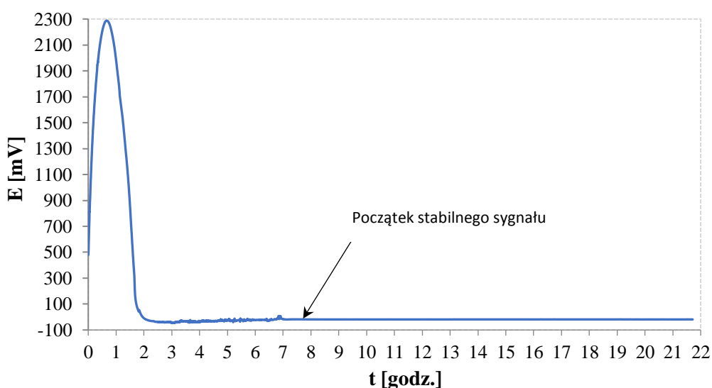
Wykres 9. Pomiar stabilności podczas kondycjonowania wykonanej elektrody odniesienia względem ORION 800500U.
