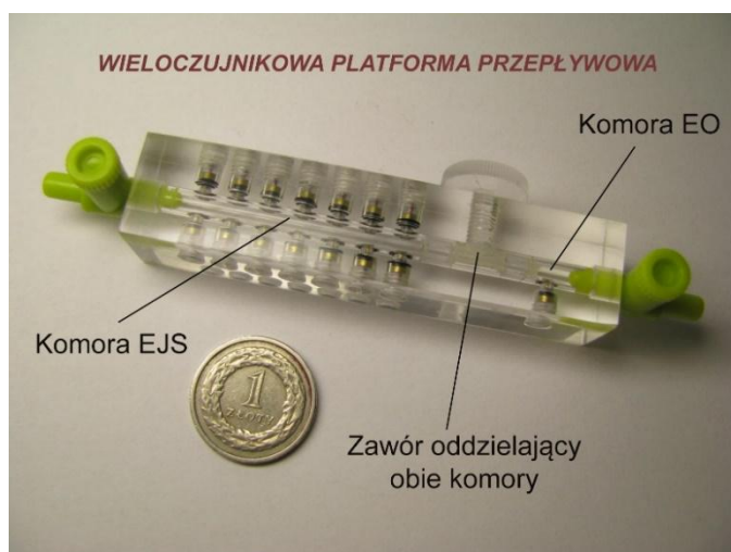
Zdjęcie 22. Konstrukcja przepływowej WPP.
