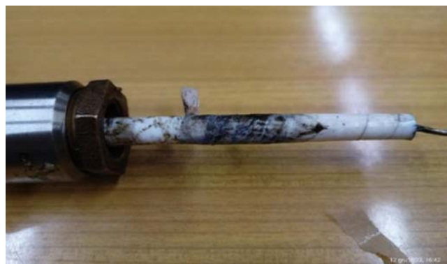
Rys. 12 Uszkodzony rdzeń izolatora
