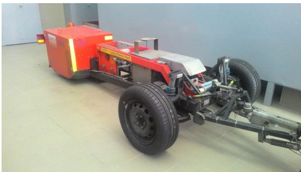
Rysunek 36. Przyczepa R 2 Mk.2 do pomiaru współczynnika oporu toczenia opon i nawierzchni (materiał własny)
