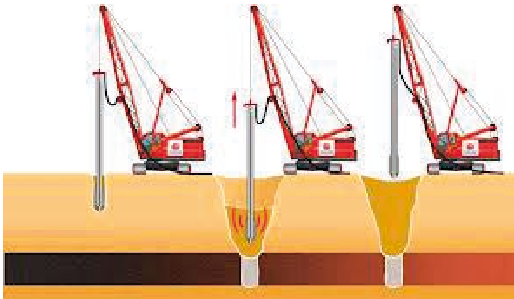
Rys. 2. Schemat wykonywania kolumn MMC
