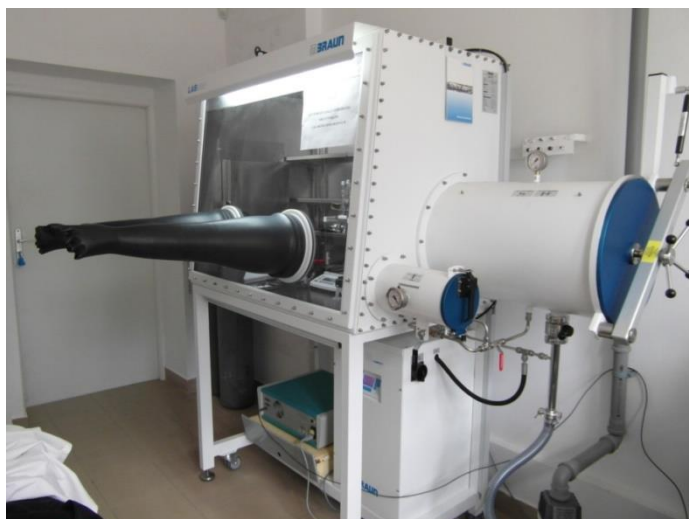
Rys. 6 Komora rękawicowa mBraun Labstar wykorzystana przy syntezie oraz badaniach materiałów anodowych
