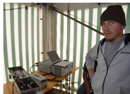
Doktorant, Wojciech Leśniewski, konstruktor układu zasilania i sterowania łodzi solarnej czeka na wynik pomiarów pojemności akumulatorów. Po lewej stronie, na stole, poddawane jest badaniom serce naszej łodzi wodoszczelna „trumienka” z elektroniką i akumulatorem
