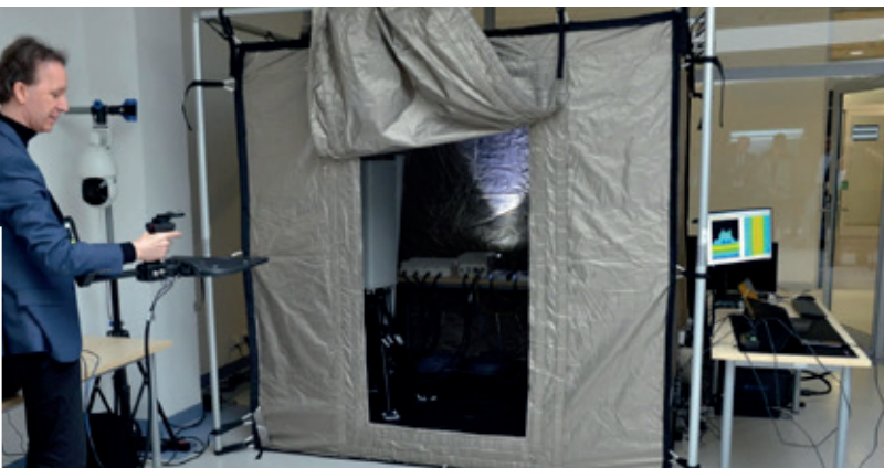
Fot. 1. Dr inż. Krzysztof Gierłowski przedstawia możliwości badań systemów RAN w zamkniętym środowisku propagacyjnym, jakim jest specjalizowany, ekranowany namiot
