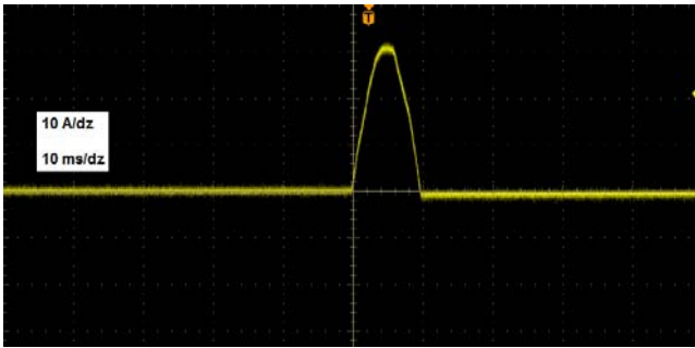
Rys.5. Oscylogram prądu pomiarowego miernika 1. Czas przepływu prądu 10 ms, wartość szczytowa prądu 30 A
