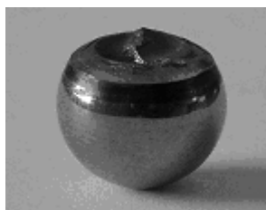
Rys. 10. Charakter pęknięcia kulki górnej obciążonego czterokulowego wężła tarcia tocznego smarowanego emulsją wodno-olejową HFA-E [L. 10, 11]
