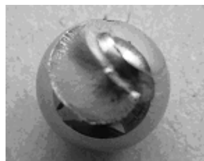
Rys. 11. Charakter pęknięcia kulki górnej obciążonego czterokulowego wężła tarcia tocznego smarowanego wodą destylowaną [L. 10, 11]
