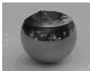
Rys. 10. Charakter pęknięcia kulki górnej obciążonego czterokulowego wężła tarcia tocznego smarowanego emulsją wodno-olejową HFA-E [L. 10, 11]
