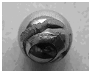
Rys. 11. Charakter pęknięcia kulki górnej obciążonego czterokulowego wężła tarcia tocznego smarowanego wodą destylowaną [L. 10, 11]
