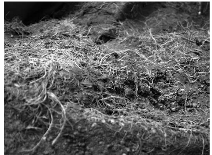
Rys. 11. Kolmatacja geowłókniny pyłem i korzeniami roślin
