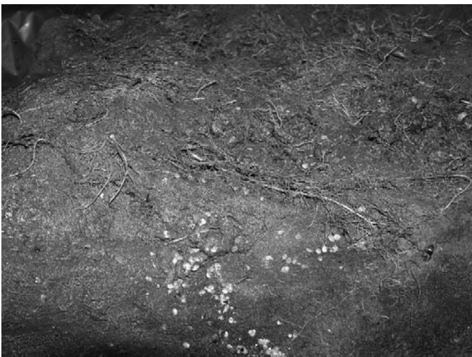
Rys. 11. Kolmatacja geowłókniny pyłem i korzeniami roślin
