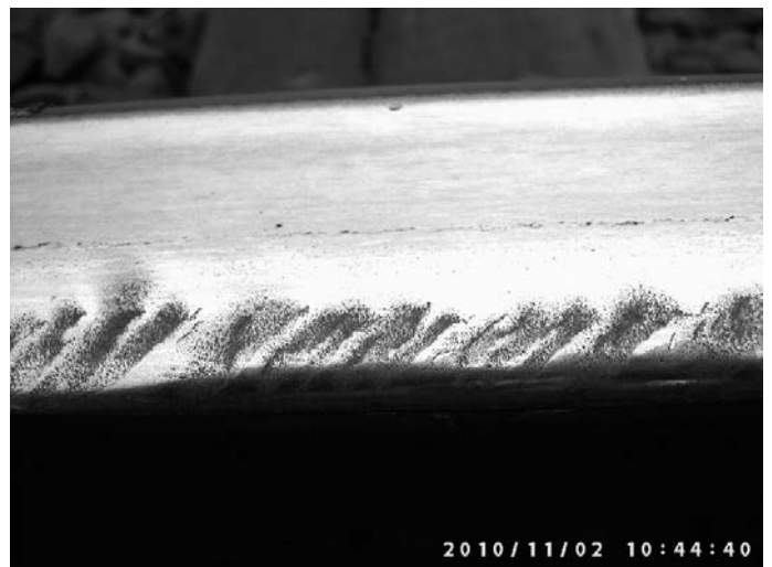
Rys. 14. Wady head check na powierzchni tocznej opornicy
