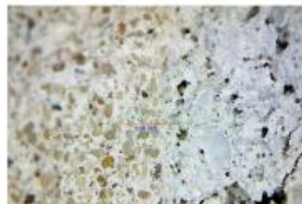
FOT. 10. Struktura tynku maszynowego (gipsowo-wapiennego) dla przypadku powiększenia 100-krotnego; fot.: autorzy
