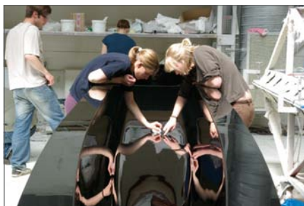
Rys. 7. Polerowanie idealnie gładkiej formy (Fot. W. Leśniewski)
