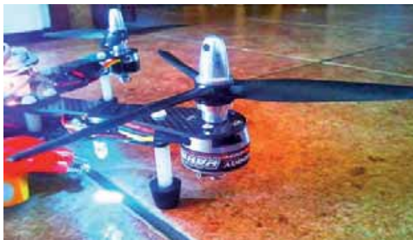
Rys. 3. Mocowanie silnika ze śmigłem do ramy
