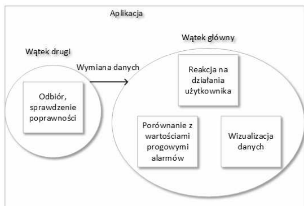
Rys. 2. Schemat blokowy działania warstwy programowej [6]
