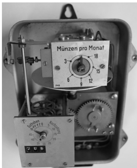
Rys. 2. Wnętrze licznika RZK1, widok od przodu [5]
