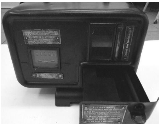
Rys. 5. Wygląd licznika GSLJc z otwartym pojemnikiem [6]
