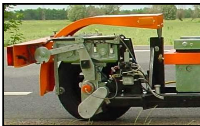
Rys. 14. Zawieszenie koła badanego i część toru pomiarowego w przyczepie R 2 Mk.1 wersji pierwszej.
