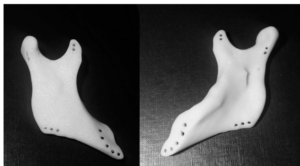
Rys. 8. Gotowy implant indywidualny wykonany technologią druku 3D
