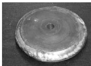
Rys. 2. Napoina jednowarst-wa składająca się z trzech ścię-gów wykonywana na krążku ze stali X40CrSiMo10-2
