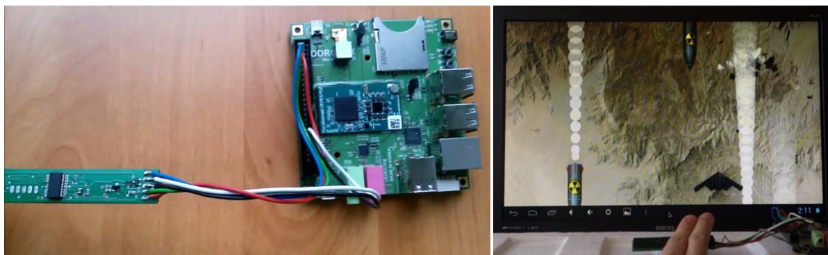
Rys. 5.2 a) Połączenie czujnika optycznego z komputerem jednopłytkowym Odroid-X (przewody: zasilający V_{DD} , napięcia odniesienia V_{REF} , masy GND oraz odbioru i wysyłania danych Rx, Tx). b) Dłoń sterująca ruchem samolotu za pomocą optycznego czujnika gestów podłączonego do urządzenia Odroid-X.
