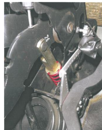
Rys. 10. Potencjometr zamontowany przy dźwigni przyspieszenia pojazdu [5].
